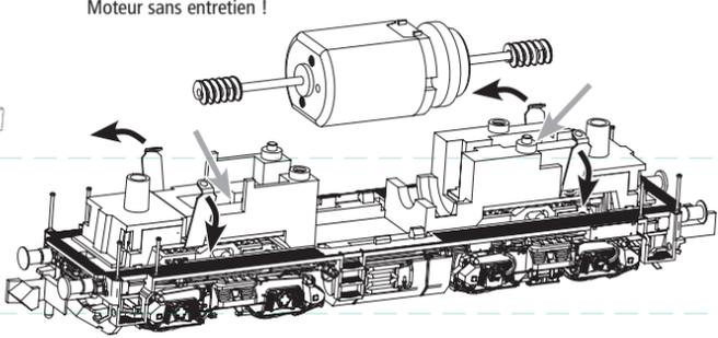
**Einbau eines digitalen Empfängerbausteins:**
